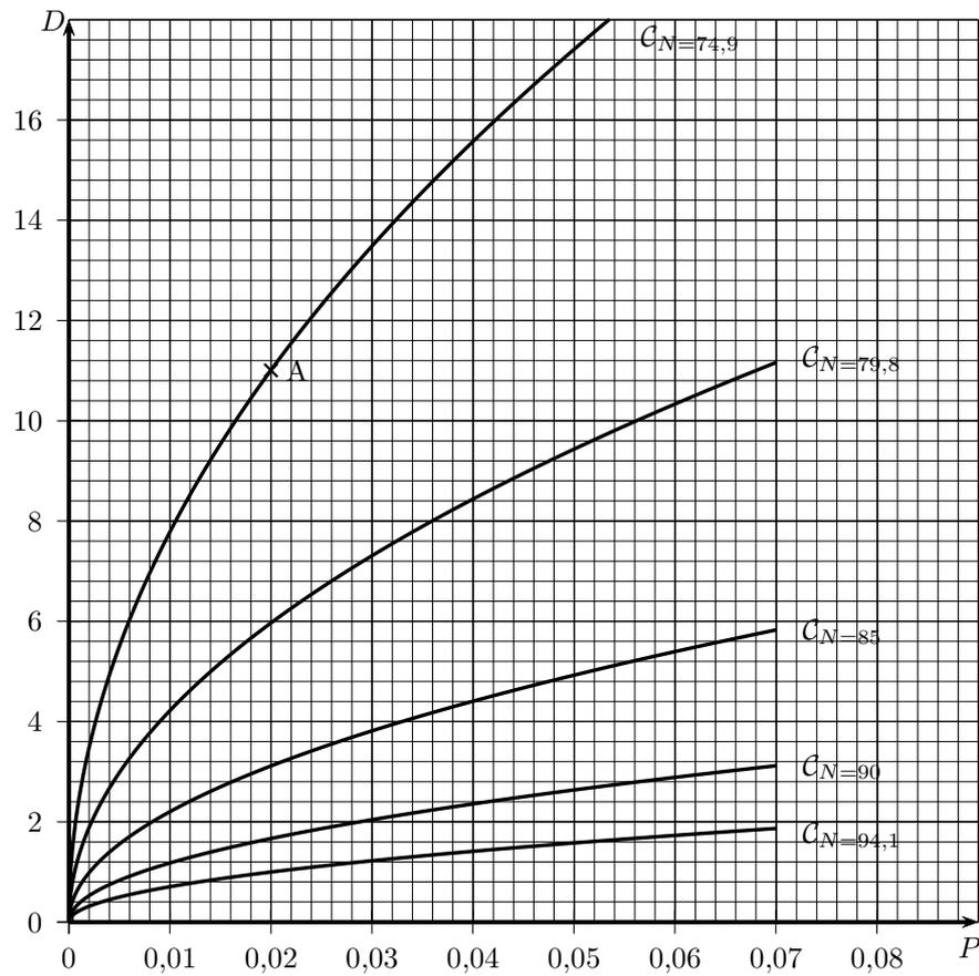
On admet que pour une puissance de 0,02 Watt, le niveau sonore du bruit est de 74,9 décibels à une distance de 11 mètres de la source sonore. Ainsi, le point A de coordonnées (0,02; 11) appartient à la courbe  $C_{N=74,9}$ .
